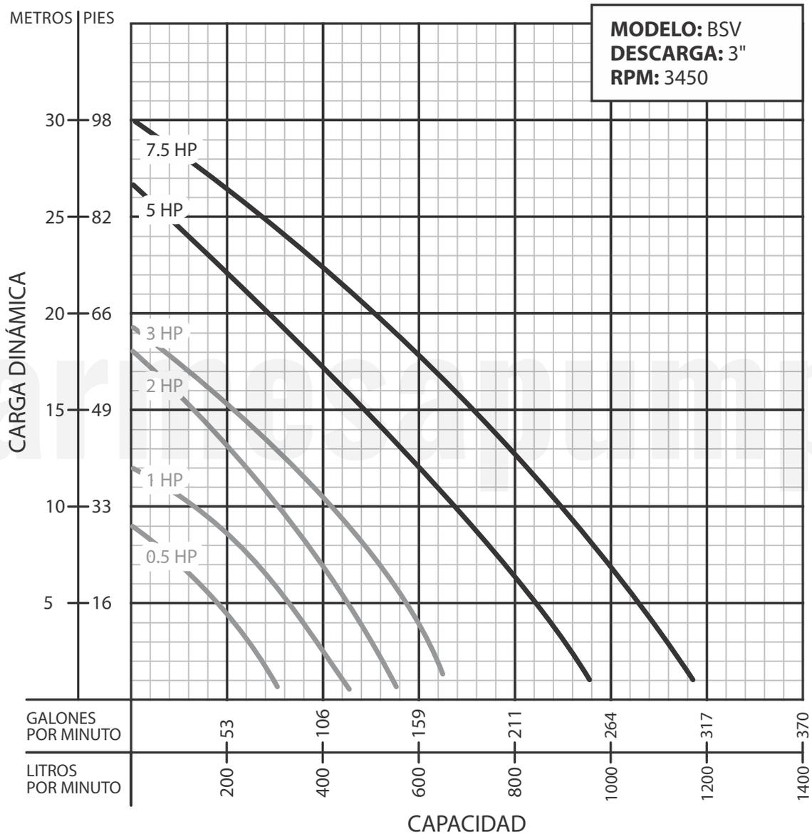
Prueba realizada con agua, gravedad específica 1.0 @ 20 °C (68 °F); otros líquidos pueden variar el rendimiento.
