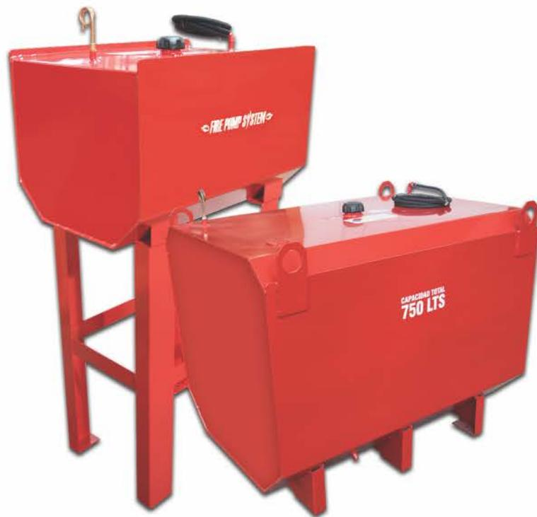
Este tipo de tanques se usa en equipos contra-incendio y se deben dimensionar en base a la norma NFPA 20, que dice que el tanque de combustible deberá tener una capacidad como mínimo de 1 galón por HP y considerar 5% más por sedimentos y otro 5% por expansión.
